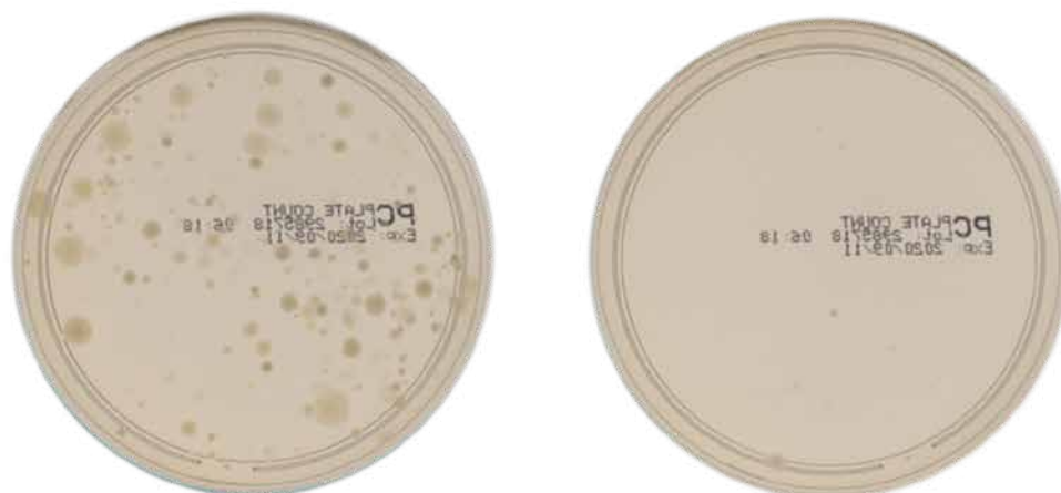
Número total de colonias de gérmenes (manchas oscuras) en la muestra aleatoria no tratada de la fase de clarificación de agua en el clarificador (izquierda) y en la muestra tratada (derecha).
